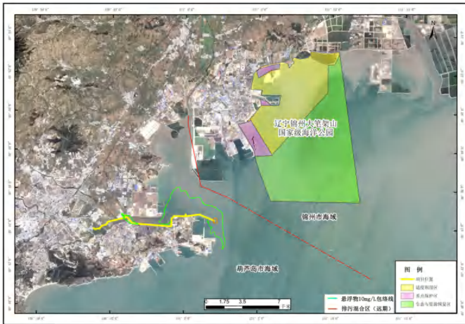
图 6.4.1-9 施工期悬浮物及运营期污染物扩散包络线与锦州大笔架山国家级海洋特别保护区叠图
