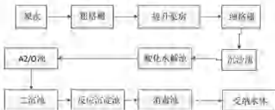
图 3.2.2-2 高新区污水处理厂处理工艺流程
