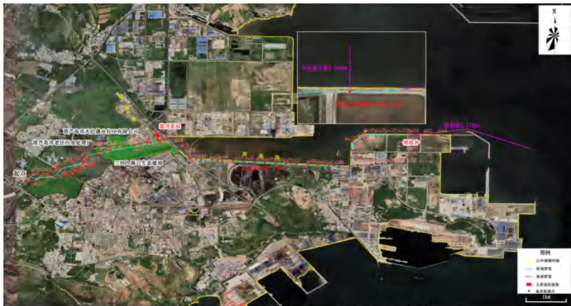
图 5.3-1 葫芦岛市排海管线二期工程管道路由勘测钻孔平面位置图
